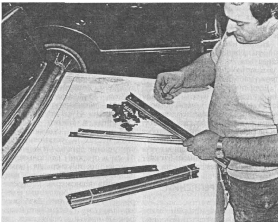
Не забудьте эти элементы жесткости для отверстий для шурупов. Без них будет слишком большое давление на прутья багажника и на листовую металл крышки багажника.
