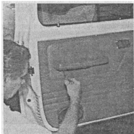
А вот дверная панель нашей машины. Я не могу даже представить, что пришлось вынести динамикам. Почти все съемные подлокотники крепятся тремя шурупами, к которым можно подобраться снизу.
