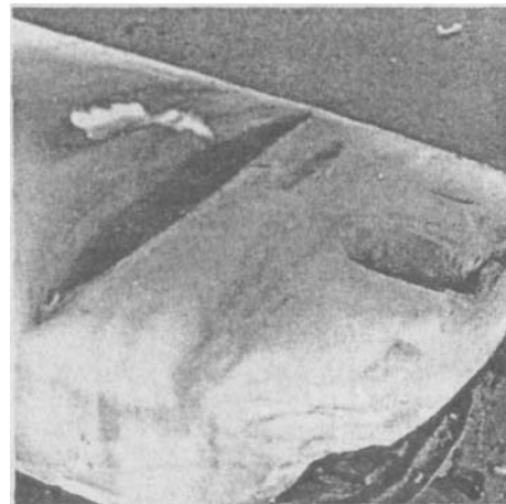
Нет, это не Большой каньон. Это всего лишь то, что происходит с поролоном, когда изнашивается обивка, а сиденье продолжает использоваться. Поролон нужно починить, иначе он будет торчать под новой обивкой.
