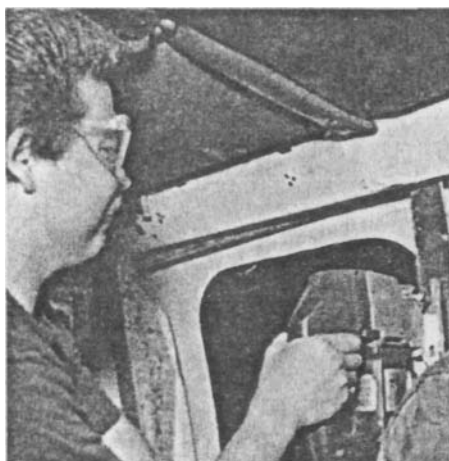
Окончательная подгонка внутри для планки боковины.
