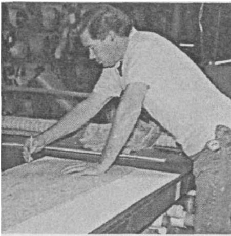
Я собираюсь обить низ доски сиденья, потому что он будет виден после установки.
