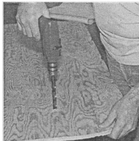
Если вы забудете просверлить отверстия для воздуха (дыхательные отверстия), то по завершении работы ваша подушка сиденья постоянно будет сырой.
