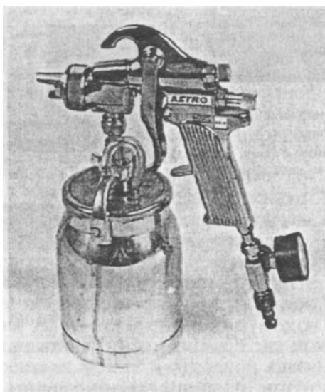
Для нанесения на поверхности материала клея отделочники часто используют пульверизаторы пистолетного типа. Обратите внимание — пульверизатор имеет манометр, что позволяет вам установить определенное давление. Если давление будет слишком высоким, клей станет выходить неровными струйками, напоминающими туман, а пузырьками.
