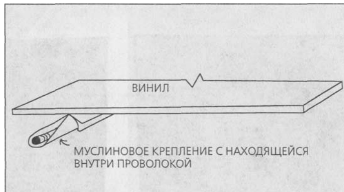
Крепление - это полоса муслина шириной 3,8 см, сложенная пополам и пришитая к детали из винила или ткани. В эту петлю может быть вставлен прут или проволока. Если вы используете для закрепления что-нибудь вроде булавок с кольцами, то это даст вам возможность закрепить материал так, что крепления не будет видно.
