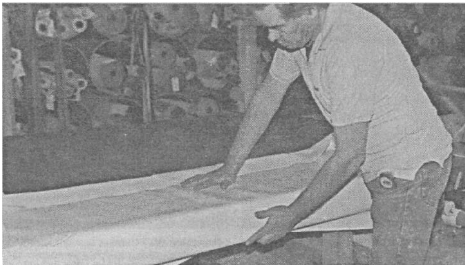
Разложите обивку, выровняв по середине, натяните ее сверху вниз, обернув вокруг подушки и закрепите гвоздиками. Это стандартная рабочая процедура.
