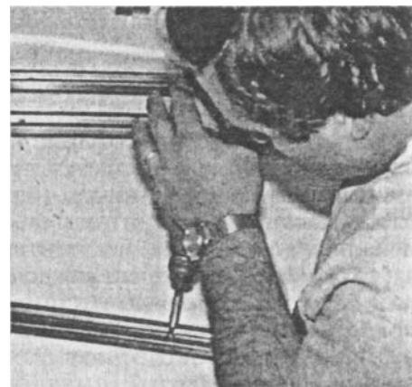
Наружные прутья багажника устанавливаются в первую очередь. Это может быть временная установка. Если они не очень хорошо располагаются, попробуйте подвигать их взад-вперед.
